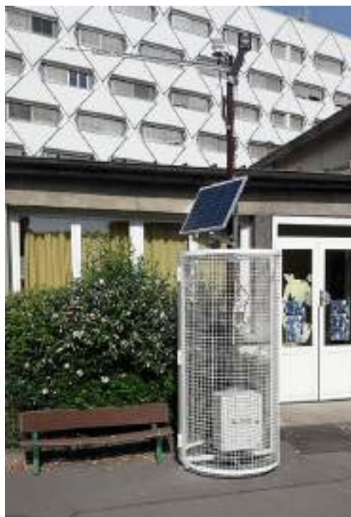
Statut météo posée dans la cour d'une école élémentaire parisienne dans le cadre du projet de recherche OASIS UIA-FEDER, afin d'évaluer le confort thermique. (crédits : LIED-Paris Diderot-ESIEE Parisweb)
