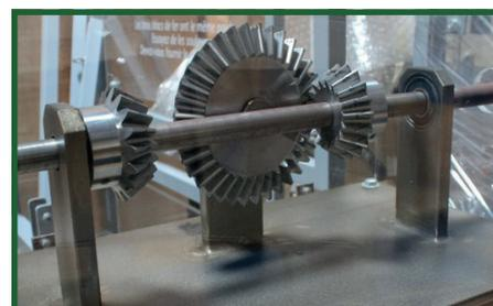
Expérimentez le fonctionnement de différents types d'engrenage et découvrez des objets qui les renferment, comme le tire-bouchon pour l'engrenage à crémaillère, ou le batteur à œuf pour l'engrenage conique.
