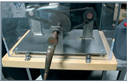
Des systèmes de transmissions pignons-chaînes et poulies-courroies vous permettent de tester ces différents procédés.
